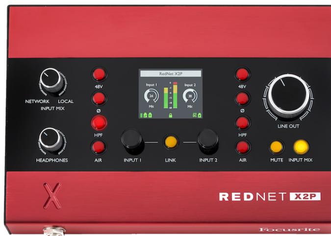
Das RedNet X2P integriert zwei lokale Red Evolution Vorverstärkerkanäle für Mikrofon-/Line-/Instrumentensignale und dient mit seinen zwei Kanälen mit hochwertiger D/A-Wandlung von Dante AoIP-Signalen (Audio-over-IP) als stereophone Abhöreinheit mit separaten Kopfhörer- und Line-Ausgängen.
